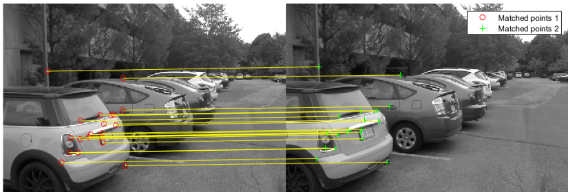
Figura 45. Ejemplo del proceso del comando 'showMatchedFeatures'.
