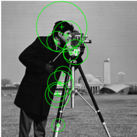
Figura 41. Ejemplo de comando 'detectSURFFeatures'.
