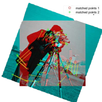
Figura 44. Resultado del proceso del comando ‘ matchSURFFeatures ’.
