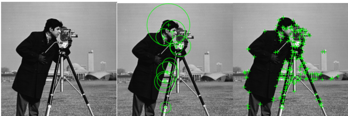
Figura 42. Ejemplo del proceso del comando 'extractSURFFeatures'.
