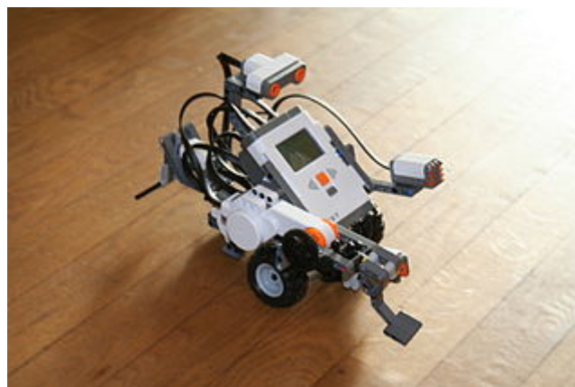
Figura 5 – Robot con sensores de distancia y sonido realizado con Lego NXT. (NXTorm, 2010)
