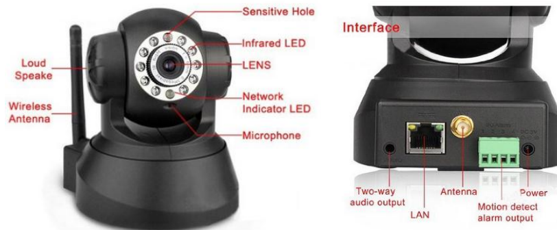
Figura 3. Características de una cámara IP Corriente
