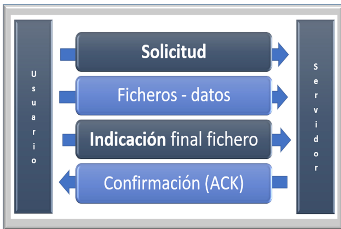
Figura 3. Protocolo de correo electrónico de 4 pasos.
