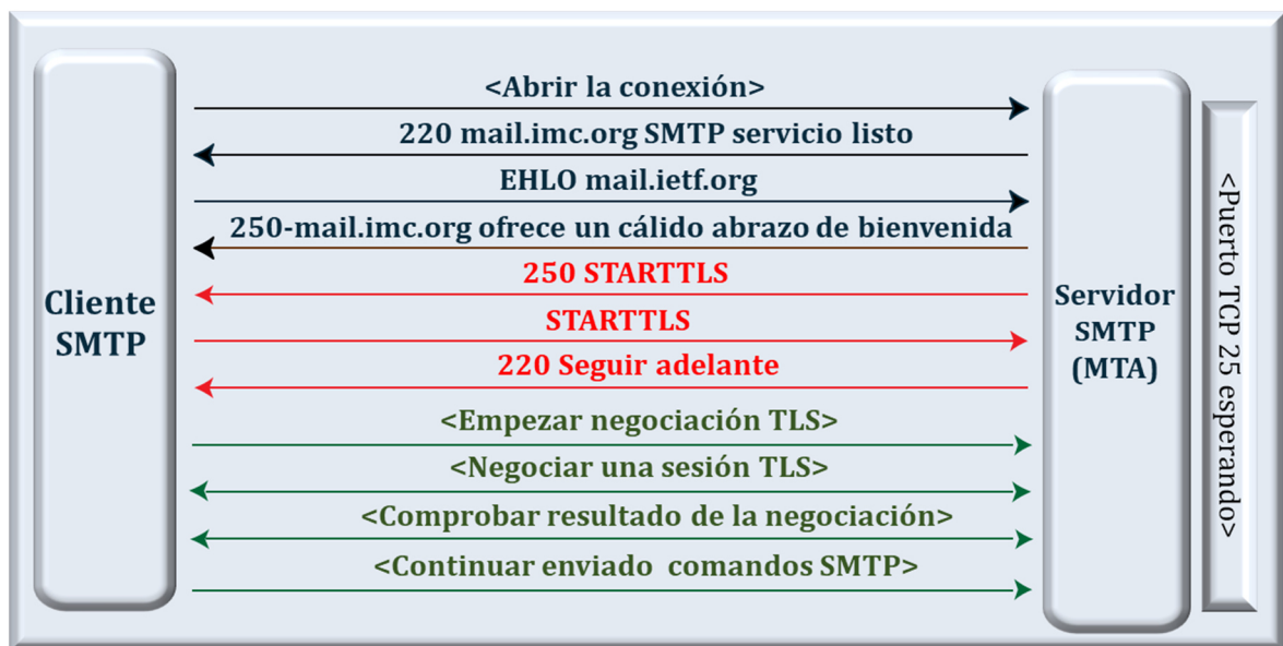
Figura 16. Sesión STARTTLS de SMTP entre cliente y servidor.
