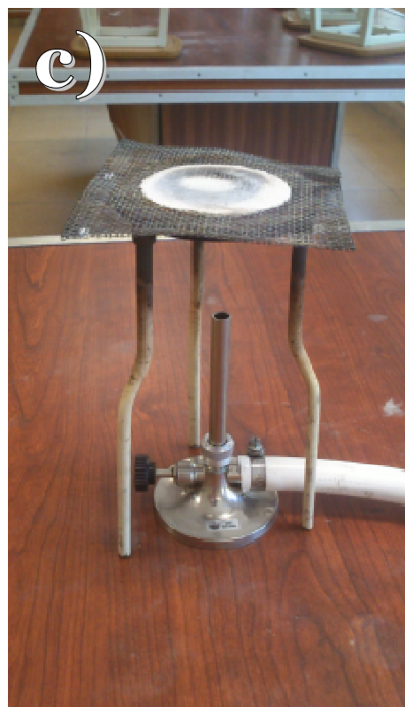
Figura 6. Mecheros fijos en el laboratorio químico del colegio San José de Calasanz. a) Instalación de gas en el laboratorio. b) Detalle de la llave de paso del mechero. c) Mechero con soporte y rejilla. (Fuente: Elaboración propia)
