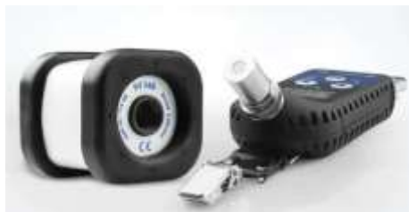
Figura 30. Calibrador acústico SV 104, usado para muestreo de ruido personal.
