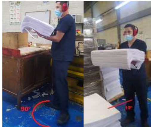
Figura 49. Ángulo de asimetría para calcular el factor AM del levantamiento y la colocación de la ecuación NIOSH.
