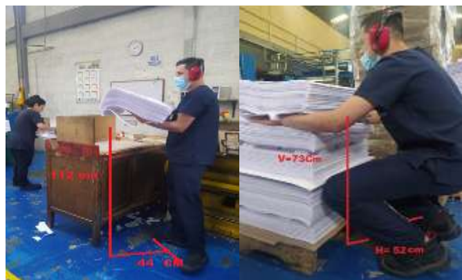
Figura 46. Localización estándar de levantamiento y colocación, para hallar el factor de distancia Horizontal (HM) y factor de distancia vertical (HV) de la ecuación NIOSH.
