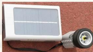
PLACA + MOTOR + EJE + RUEDA
