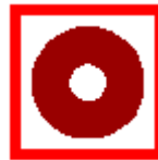
Detector de incendio
