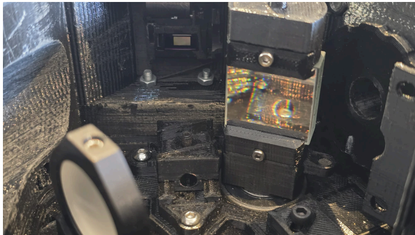
Figura 29. Fotografía en la que se ve el DMD desde la perspectiva del espejo enfocador.
