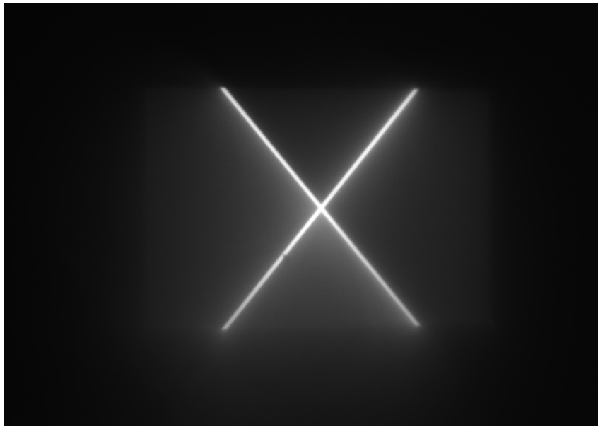
Figura 31. Espectro de lámpara de Neón obtenido en el plano del DMD y reflejado por el DMD a la cámara de test.
