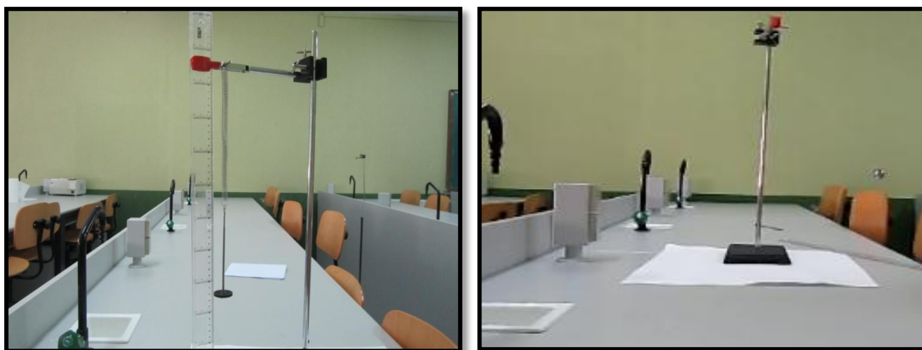
Figura 5: Imágenes de las prácticas realizadas, ley de Hooke (izda.) y Ley del Péndulo (dcha.).
