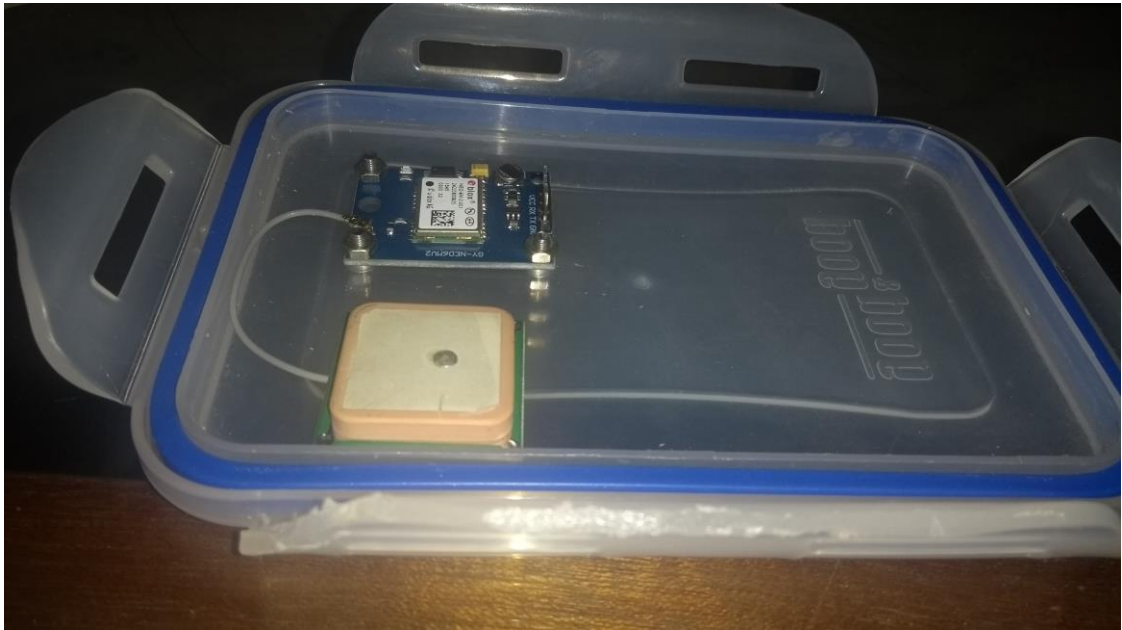
Ilustración 77. Instalación del GPS y su antena en la parte interna de la tapa del contenedor.
