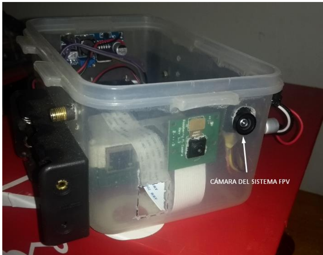
Ilustración 80. Cámara instalada para el sistema FPV.
