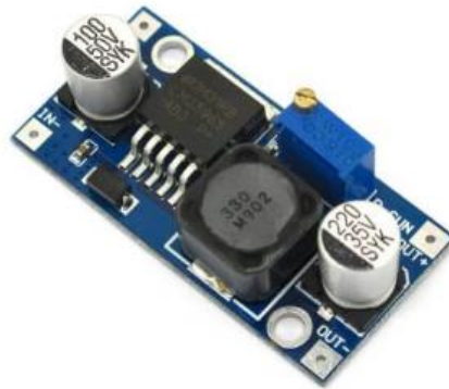
Ilustración 19. Módulo regulador de voltaje LM2596 [43]
