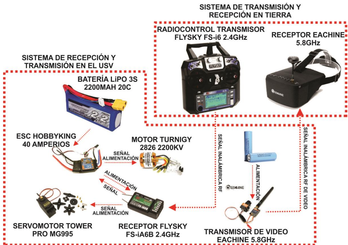
Ilustración 21. Arquitectura de componentes instalados en el USV
