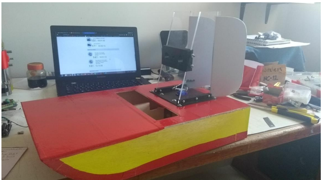
Ilustración 65. Barniz amarillo y forraje del USV con papel adhesivo vinilo de color rojo.
