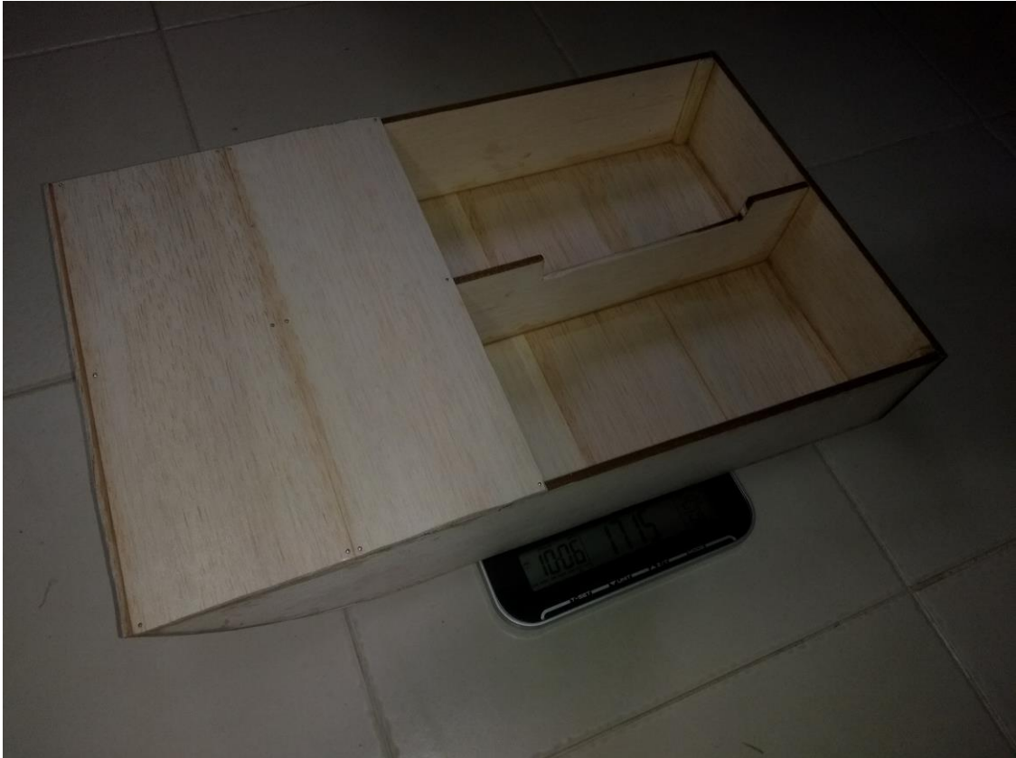
Ilustración 54. Fabricación de la superficie flotante del USV en madera.
