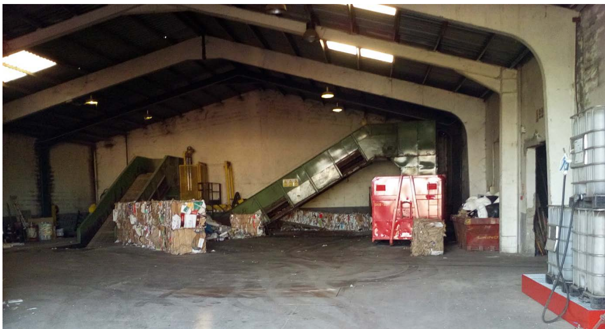
Figura 10. Prensas lineales para compactación de residuos valorizables y balas de cartón. (Elaboración propia, 2018).
