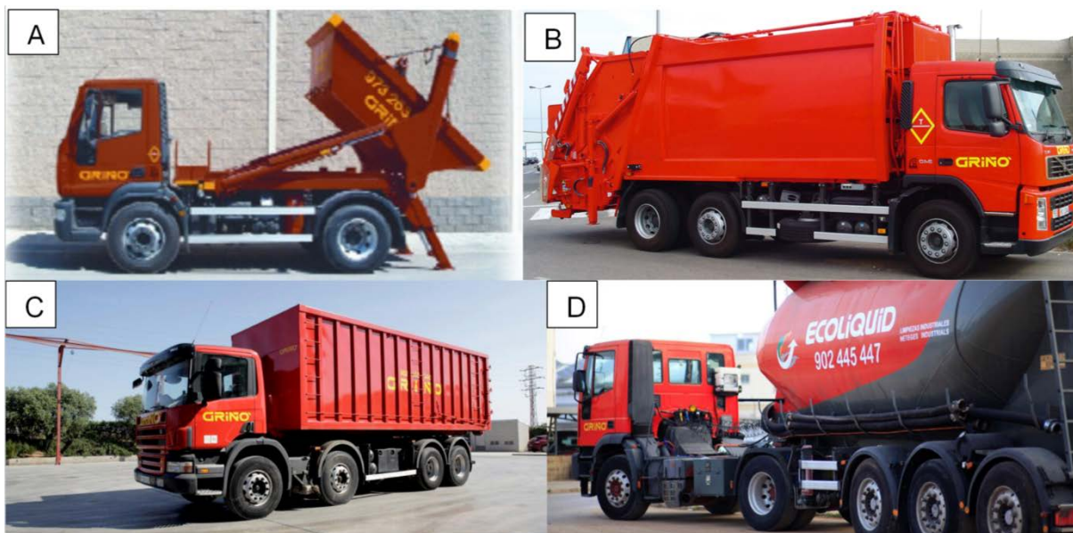
Figura 6. Camiones conducidos por los chóferes. A: Camión Cadenas. B: Recolector. C: 4 ejes rígido. D: Tractora con remolque de tipo cuba depresora. (Griño Ecologic, 2018).
