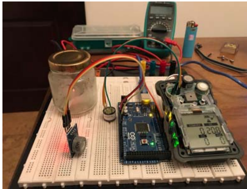
Figura 56. Preparación de Arduino + sensor de CO y equipo especializado + sensor de CO
