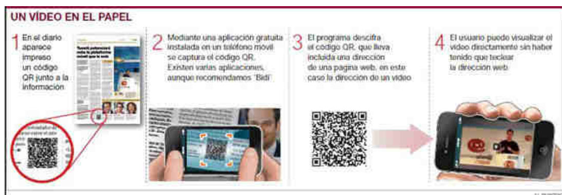
Imagen 3: Ejemplo de funcionamiento de un código QR.
