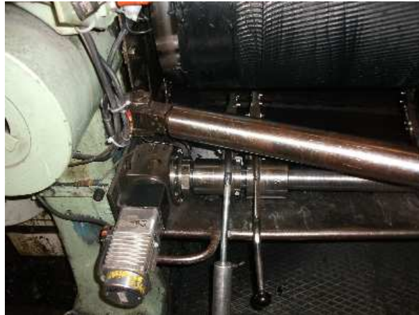
Figura 7: Detalle de barra de distribución de goma en módulo de alimentación (Sin goma en barra de distribución) (Elaboración propia.)
