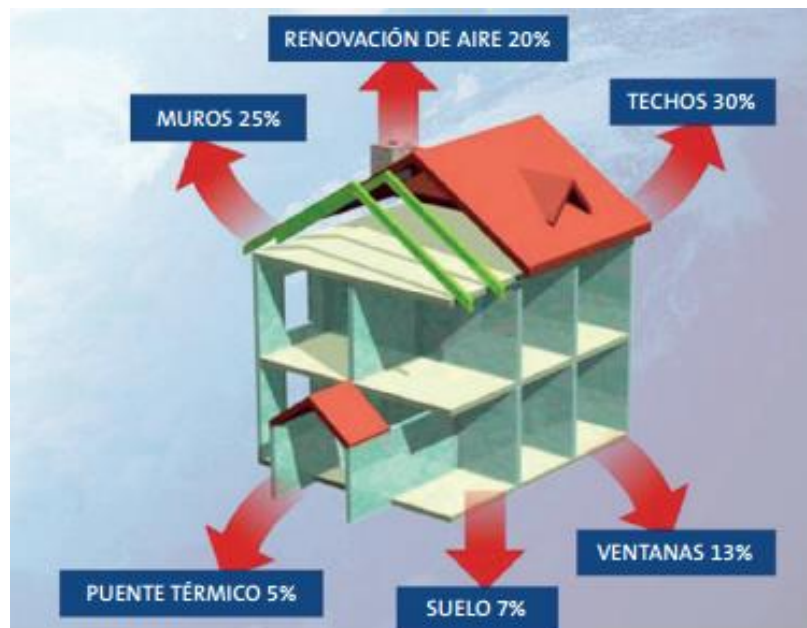
FIGURA 22. PORCENTAJE APROXIMADO DE ENERGÍA PÉRDIDA POR CERRAMIENTO DE LA VIVIENDA (ISOVER, 2014, p.3)
