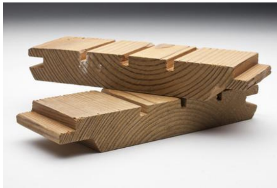
Figura27. Thermowood, Madera modificada térmicamente. (Materfad, s/f)
