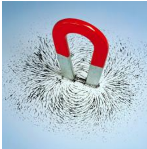
Ilustración 6. Imán con forma de herradura y virutas de hierro situadas en las líneas del campo magnético (BBC, 2014)
