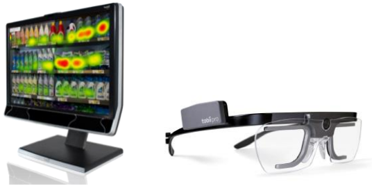
Figuras 21 y 22. Eye tracker estático y eye tracker dinámico
