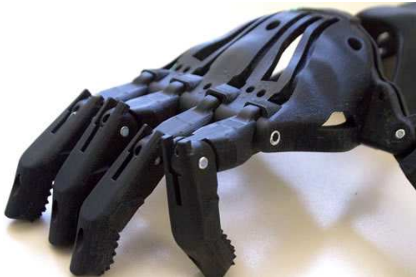
Figura 7. Brazo articulado fabricado mediante impresión 3D.
