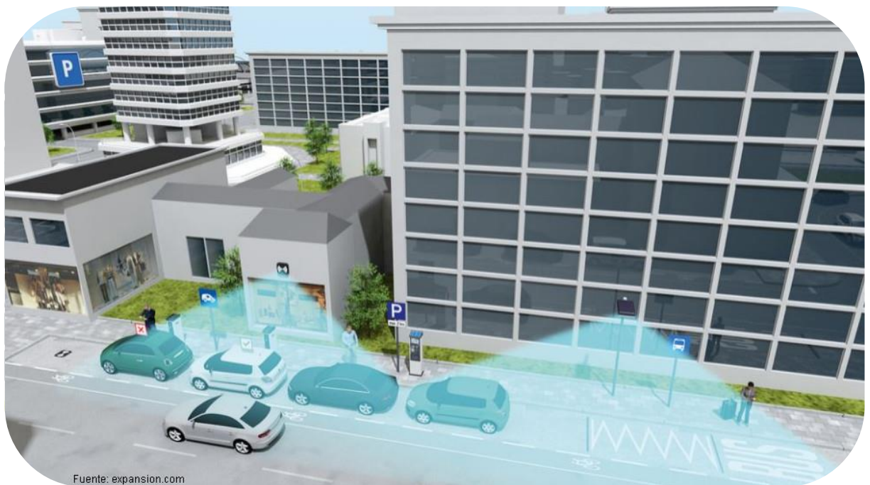
Figura 5. Aparcamiento basado en sensores instalados en farolas
