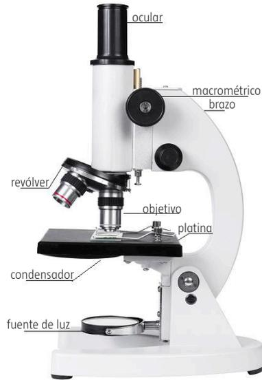
**Figura 38.** Componentes de un microscopio óptico.
