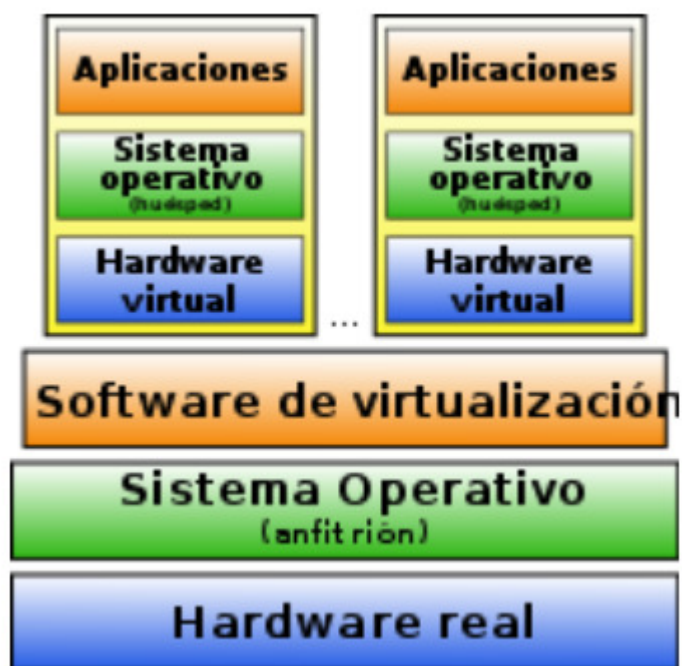
Figura 12.- Hipervisor Tipo 2: Hosted. Fuente. https://es.wikipedia.org/wiki/Hipervisor
