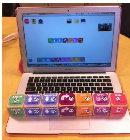
Figura 3.2 : Sistema CHERP de programación mediante bloques inteligentes.
