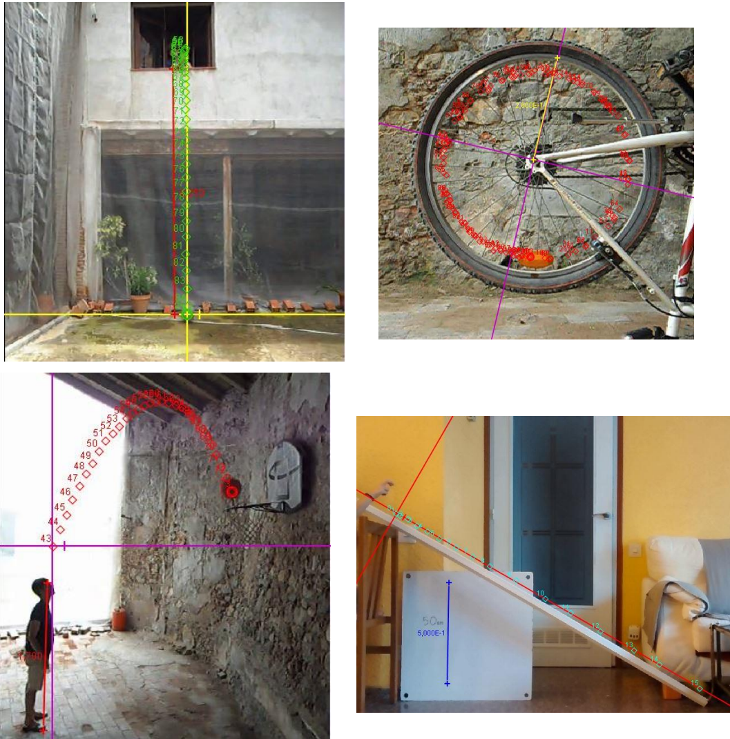
Figura 15. Seguimiento de la trayectoria de la masa puntual en cada sistema
