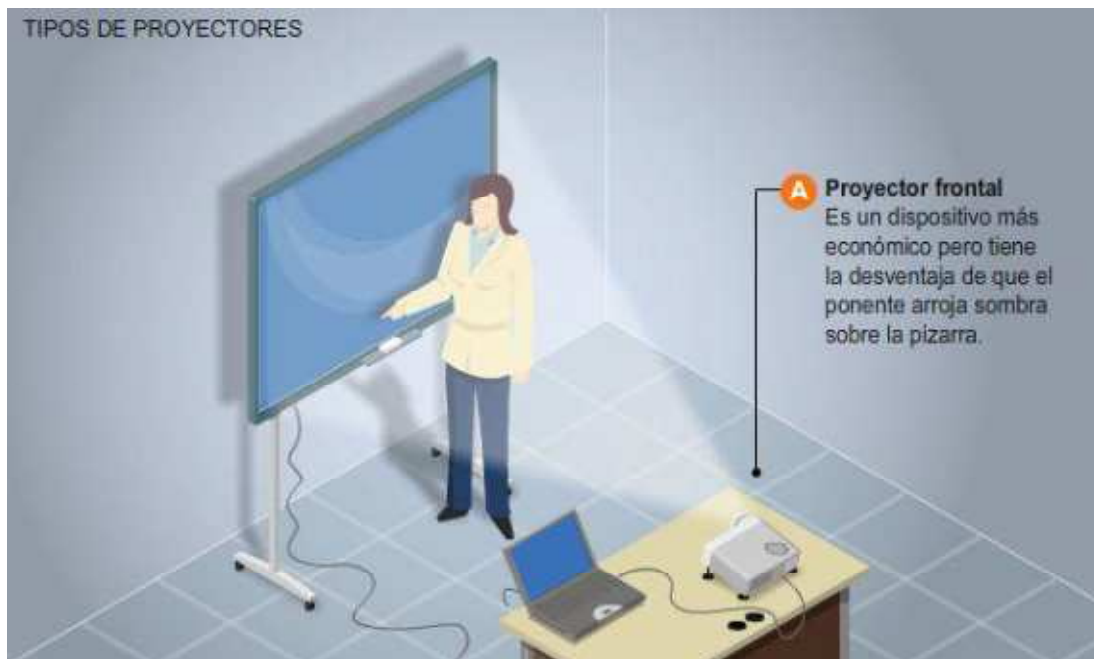
Ilustración 3. PDI con proyector frontal de media distancia. Fuente: Marqués (2003).
