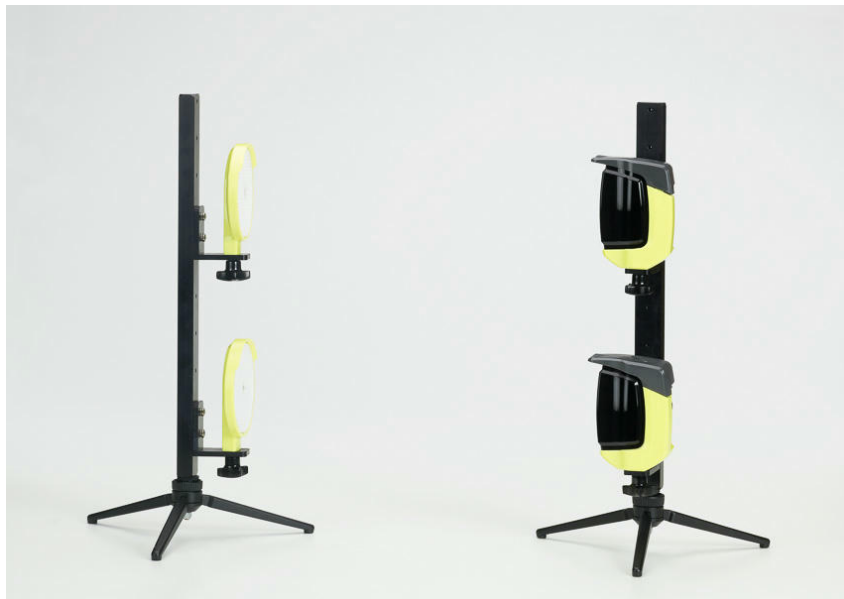
Figura 11: Disposición de las células y los espejos reflectantes. Fuente: Microgate.
