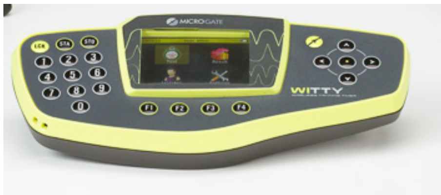
Figura 9: Consola Witty, dispositivo de lectura de las células fotoeléctricas. Fuente: Microgate.
