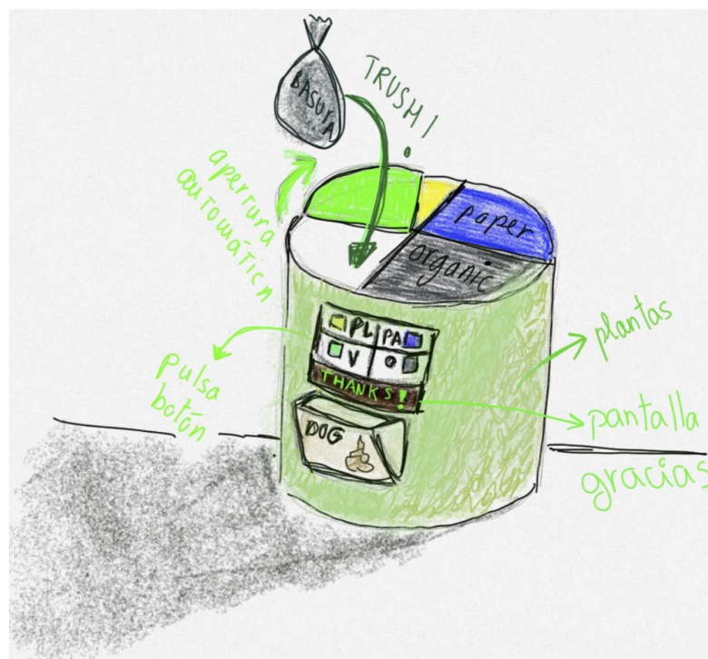
Figura 17. Conceptualización de un diseño de contenedor semisoterrado con un sistema de apertura automática.
