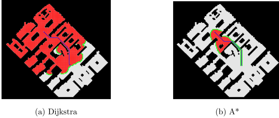
Figura 1.1: Comparación entre el algoritmo de Dijkstra (a) y el algoritmo A* (b) en una misma instancia de problema. Los nodos visitados se representan en rojo y los nodos en la frontera en verde. Fuente: Sturtevant (2025) .
