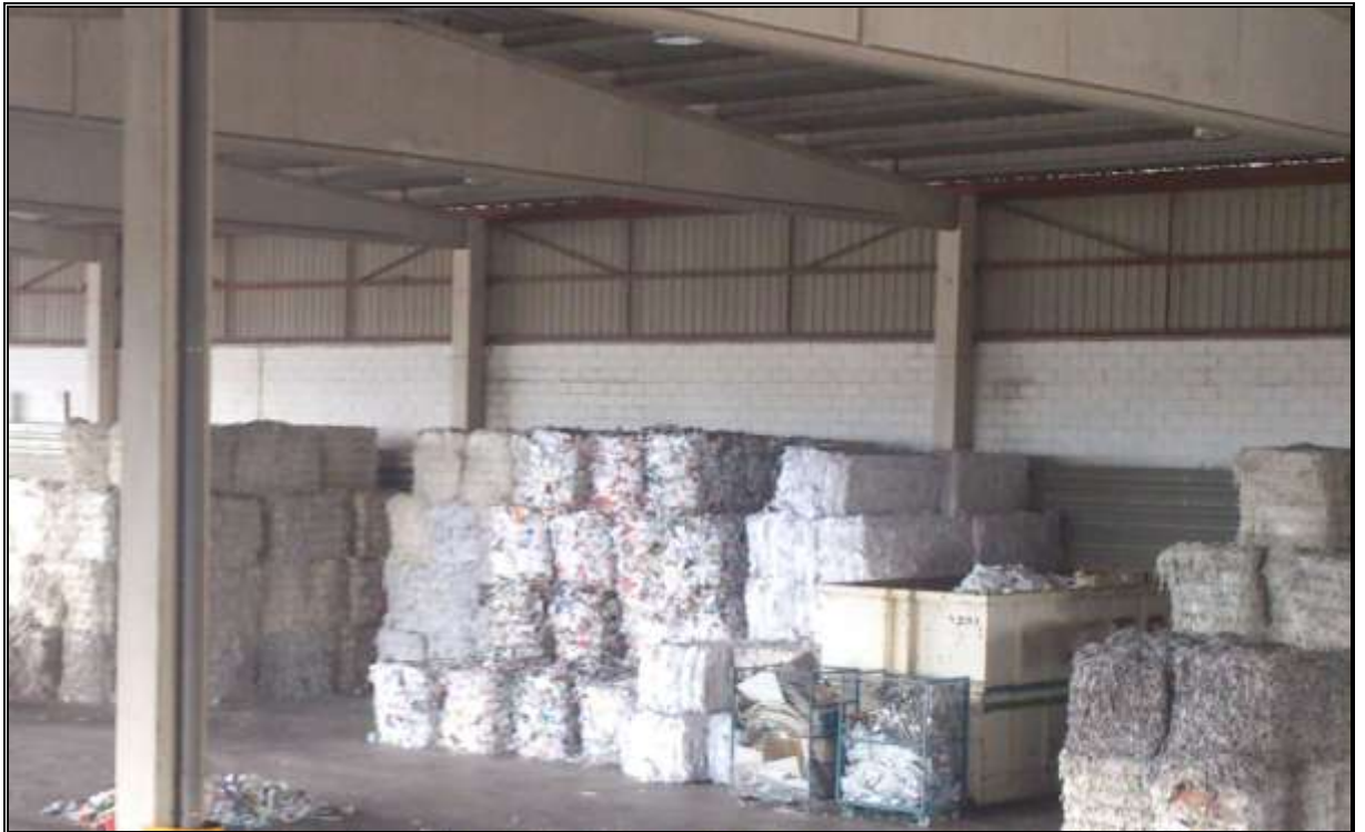
Figura 3. Balas almacenadas según calidades de papel
