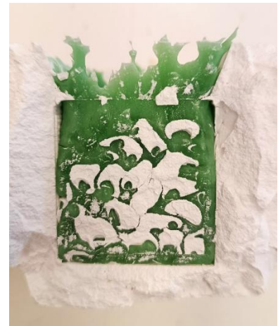
Figura 41. Molde abierto que demuestra la falta de llenado
