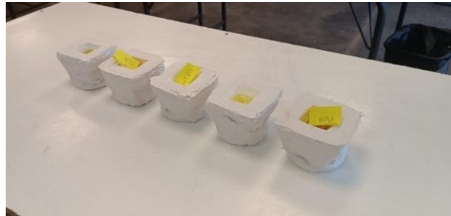
Figura 21. Cinco moldes con positivos de distintos filamentos en su interior
