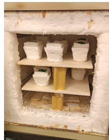
Figura 28. Horno de abertura frontal cargado con los ensayos de laboratorio de este TFM
