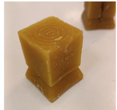
Figura 19. Modelo de cera colado en molde impreso en 3D
