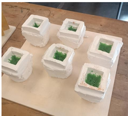
Figura 29. Moldes con vidrio luego de horneada
