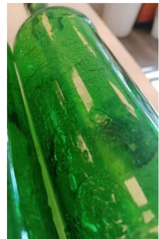
Figura 26. Botella fracturada por choque térmico
