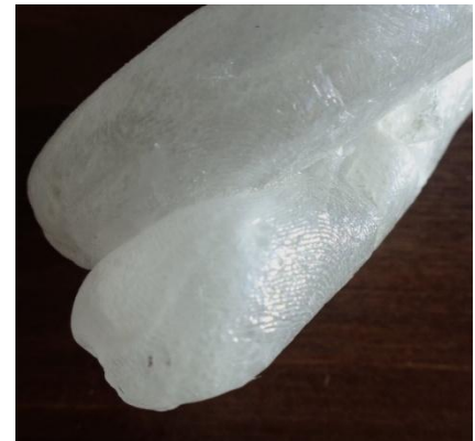
Figura 2. Huellas digitales en modelo de vidrio hecho a partir de la técnica de casting
