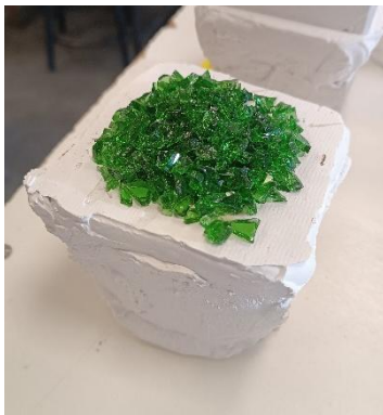
Figura 22. Molde con vidrio necesario para llenarlo sin extensión de boca de colada
