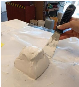
Figura 20. Construcción de un molde con mezclas fraguantes a mano
