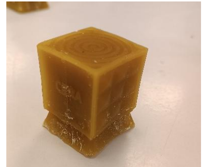
Figura 18. Modelo de cera colado en molde de alginato
