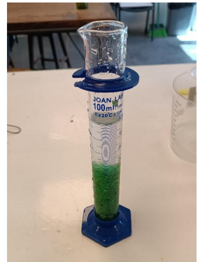
Figura 27. Medición de volumen de molienda por desplazamiento de agua
