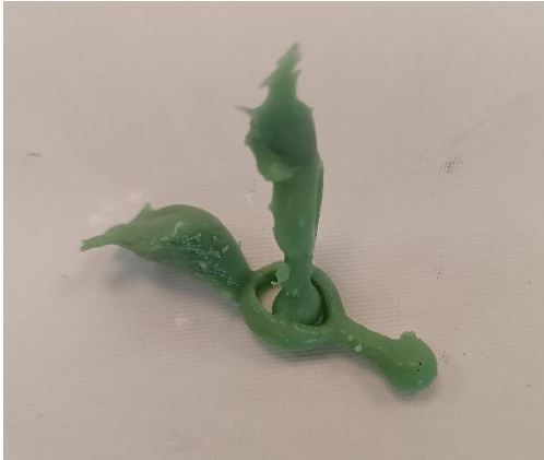
Figura 43. Dos eslabones unidos por fallo en el molde
