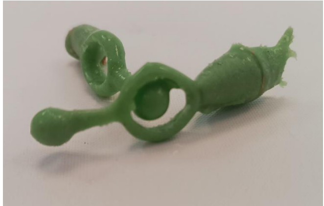
Figura 44. Dos eslabones unidos por fallo en el molde
