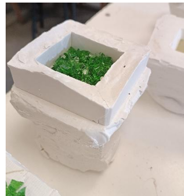
Figura 23. Molde con vidrio necesario para llenarlo con extensión de boca de colada
