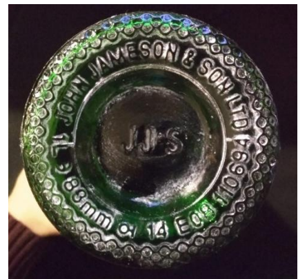
Figura 3. Ejemplo de base de botella. Fabricante de botellas: Owen Illinois
