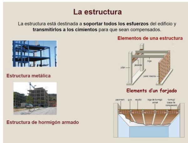
Fig 6. Diapositiva la estructura
