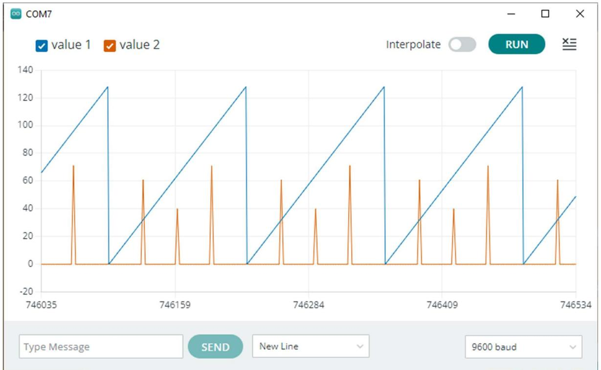
Figura 24: FFT para onda senoidal de 2KHz+4KHz+6KHz
