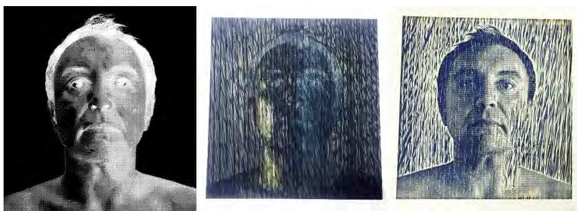
Figura 1 Corte láser aplicado al grabado en relieve. A la izquierda el archivo digital; en el centro la plancha de madera grabada con láser a partir del archivo; a la derecha la estampa resultante
