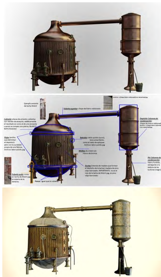
Figura 3 Proceso de trabajo seguido en la reconstrucción virtual de una de las máquinas (tacha) de la fábrica. Fuente: Proyecto Refabrica 3 Da_. GESTO y FAICO
