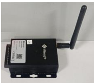
Figura 15 Equipo conversor de medios Modbus/RS-485 a LoRa
