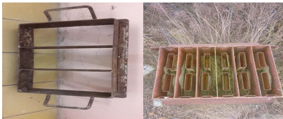
Figura 11. Moldes para ladrillo tipo panelón y hueco.
