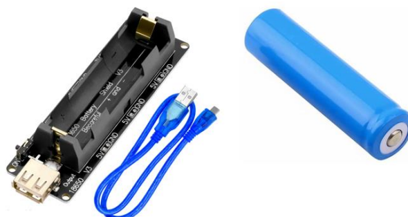
Figura 19. Alimentación y batería para sensores y microcontrolador
