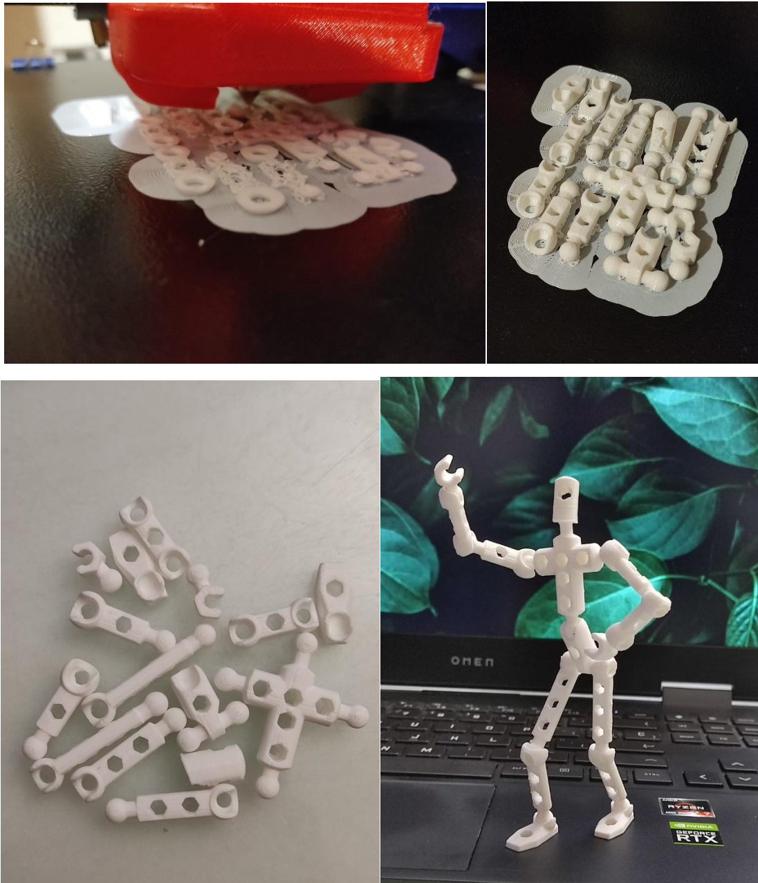
Figura 2. Impresión 3D y montaje de un modelo base.
