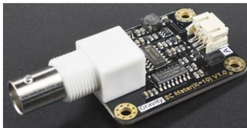
Figura 27. Sensor de conductividad eléctrica Fuente, elaboración propia.
