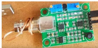
*Figura 24. Calibración del sensor de pH, vista posterior del módulo, cortocircuito en la salida. Fuente, elaboración propia.*
