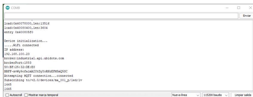
Figura 33. Comunicación exitosa entre ESP 32 y UBIDOTS. elaboración propia.
