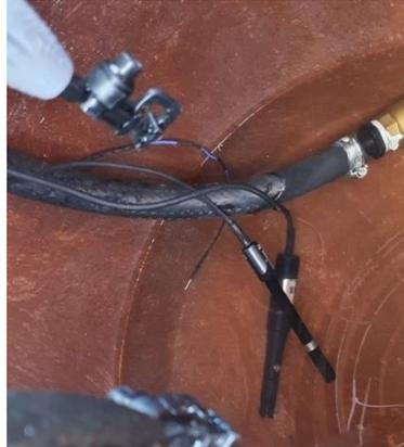
*Figura 37. Ubicación de sensores de pH, conductividad eléctrica y temperatura. elaboración propia.*
