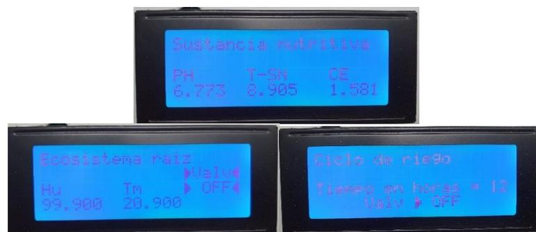
Figura 43. Visualización en pantalla de estados de; sustancia nutritiva, ecosistema y ciclos de riego. Válvula apagada. Elaboración propia.
