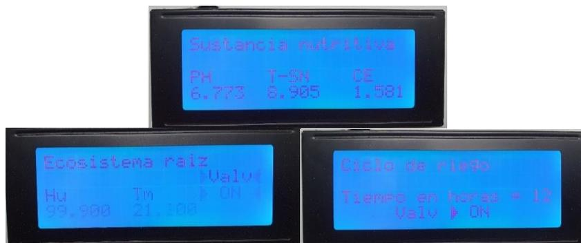
Figura 42. Visualización en pantalla de estados de; sustancia nutritiva, ecosistema y ciclos de riego. válvula prendía. Elaboración propia.
