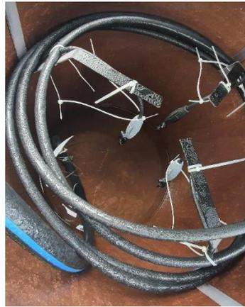
*Figura 21. Conjunto de nebulizadores con manguera de alimentación y manguera de succión. Fuente, elaboración propia.*
