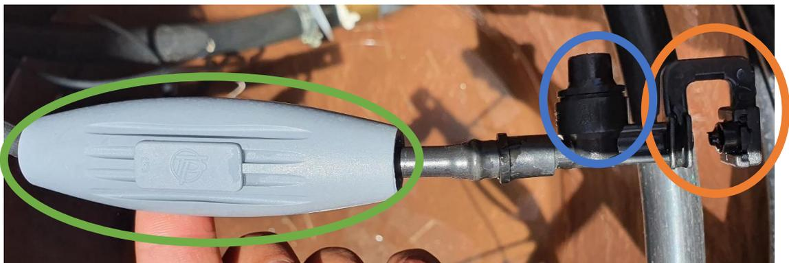
*Figura 20. Dispositivo nebulizador. En naranja el atomizador, en azul el regulador y en verde el contrapeso. Fuente, elaboración propia.*
