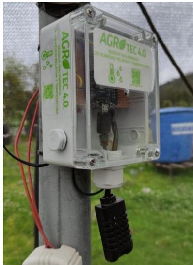
*Figura 69: Modulo sensor inalámbrico de humedad relativa y temperatura.*
