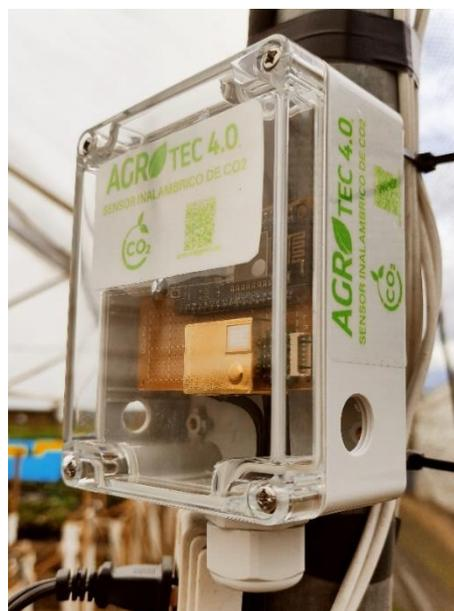
*Figura 68: Módulo sensor inalámbrico de CO2. (Elaboración propia)*
