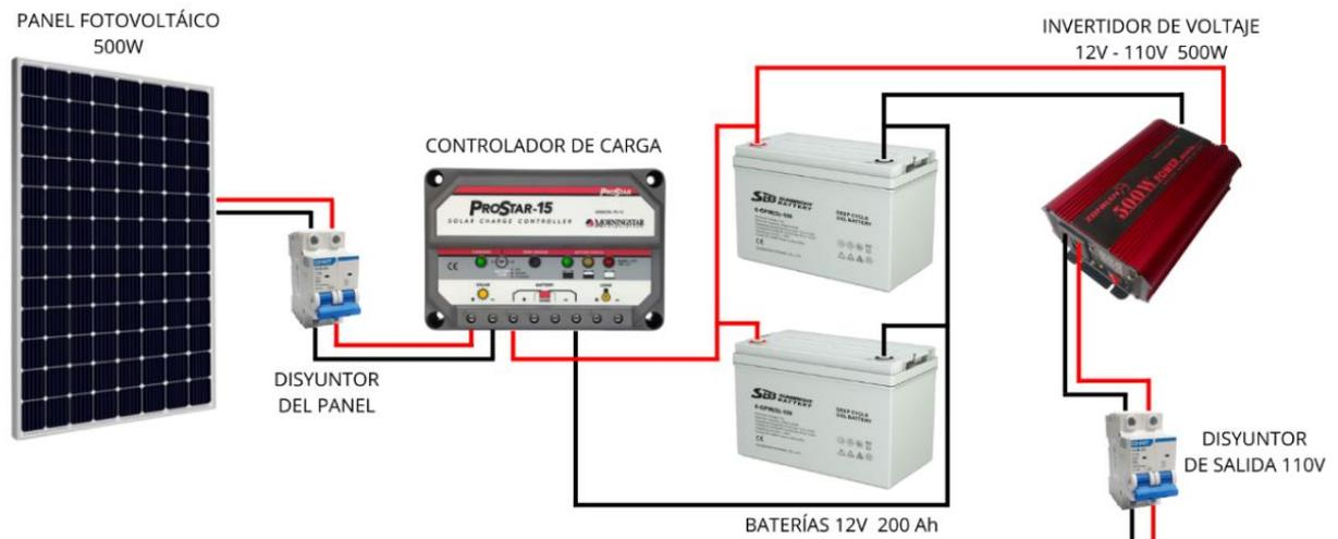
Figura 9: Configuración del panel fotovoltaico (Elaboración propia)
