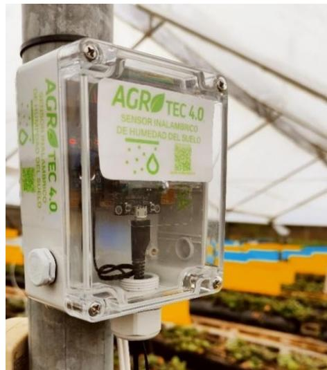
*Figura 67: Módulo sensor inalámbrico de humedad del suelo. (Elaboración propia)*
