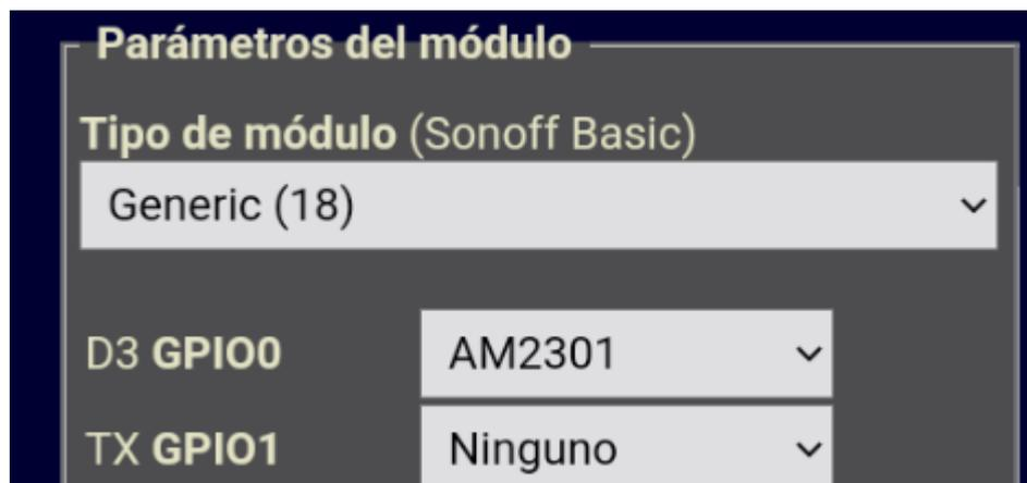
Figura 29: Parámetros del módulo sensor DHT21. (Elaboración propia)
