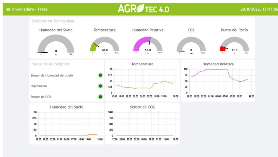
Figura 55: Dashboard para el monitoreo de cultivo de fresa. (Elaboración propia)
