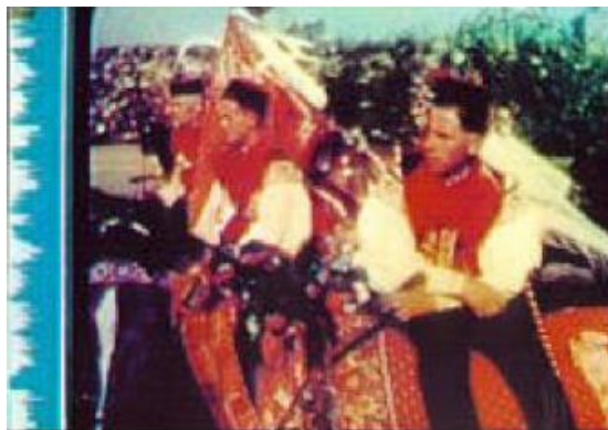
Figura 11. Película con sonido impreso por área variable
