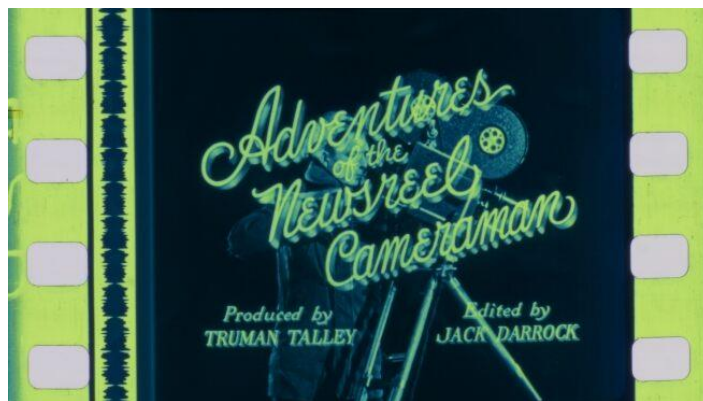
Figura 9. Apariencia del sonido óptico en el sistema Movietone
