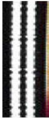
Figura 18. Banda óptica bilateral dual de área variable
