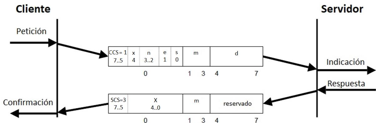
Figura 48. Protocolo SDO: Inicio de descarga.
