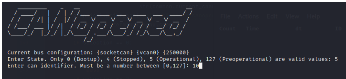
Figura 20. Inyección en el bus de un mensaje de Heartbeat (latido) de un equipo específico.
