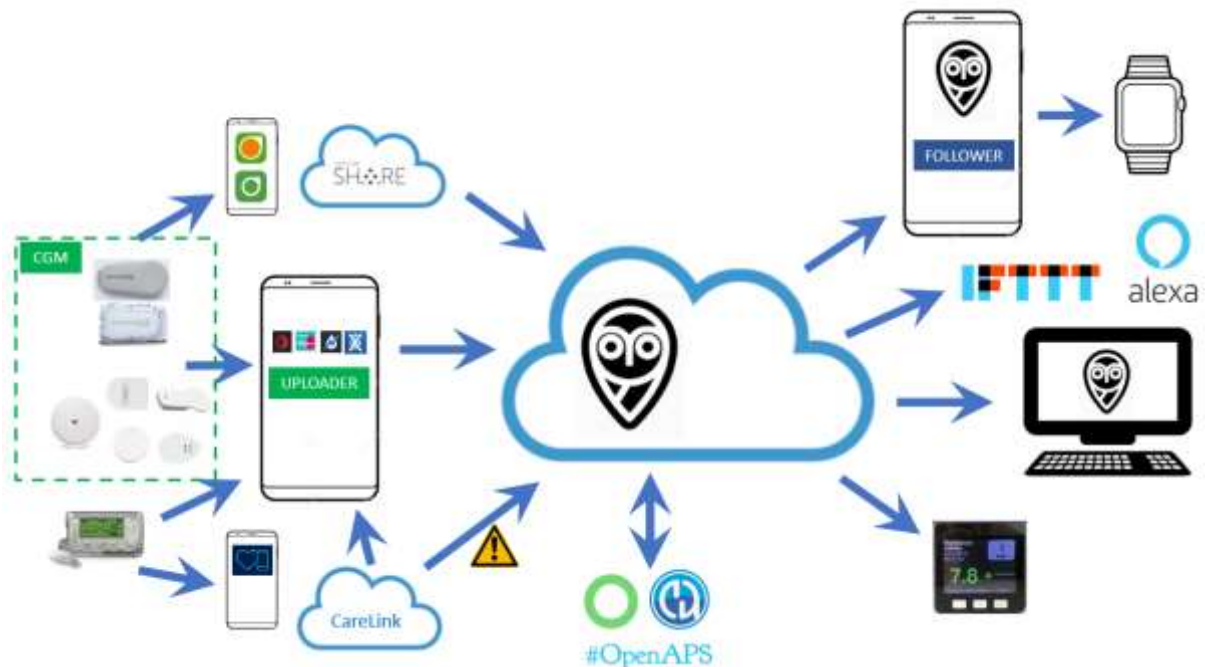
Figura 14. Esquema de funcionamiento de Nightscout (Nighscout Foundation, 2017).
