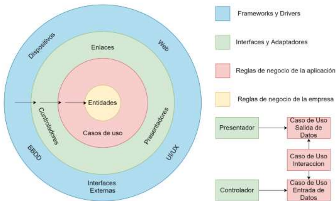
Figura 22. Diagrama concéntrico de la Arquitectura Limpia. Adaptado de (Martin, 2018).
