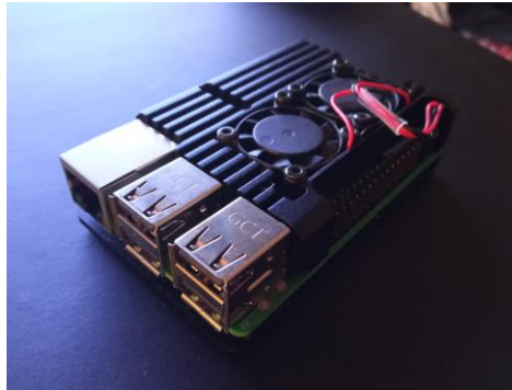
Figura 33. Mini ordenador Raspberry Pi con disipador.
