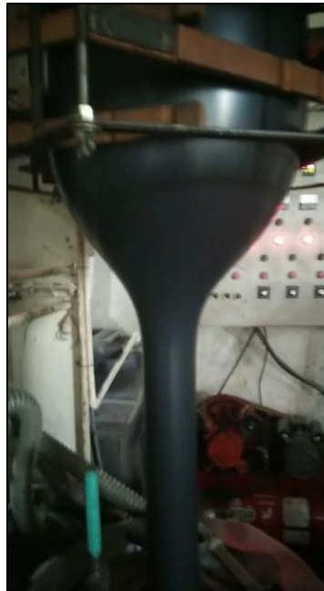
Figura 10. Extrusión tipo soplado
