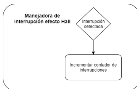
Ilustración 41. Diagrama de flujo detalle de manejadora efecto Hall
