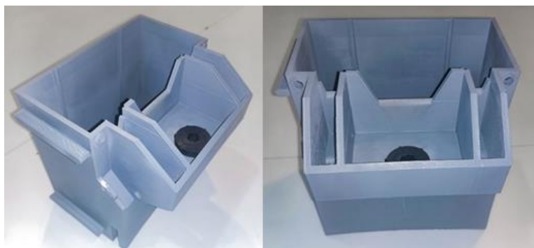
Ilustración 35. Pieza fabricada con tecnología FDM
