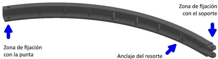
Figura 43. Brazo del limpiaparabrisas. (Elaboración propia)
