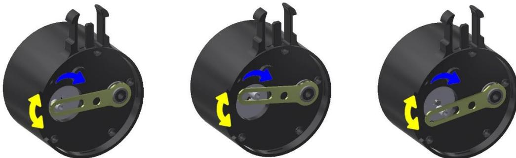
*Figura 41. Movimiento del mecanismo de manivela. (Elaboración propia)*
