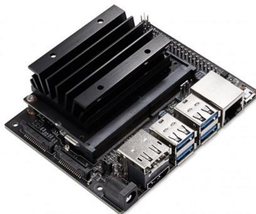
Figura 5. Imagen SBC nVidia Jetson Nano
