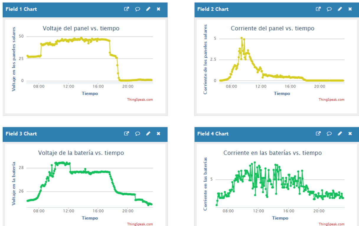
Figura 30. Parámetros del sistema fotovoltaico en ThingSpeak. (Elaboración propia)
