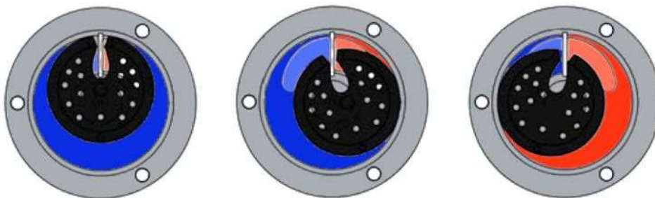
Figura 2-8 Funcionamiento del medidor de pistón oscilante
