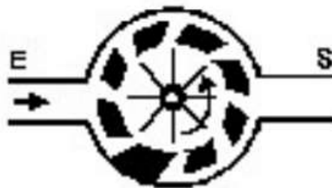
Figura 2-10 Esquema de funcionamiento de medidor de Chorro Múltiple.
